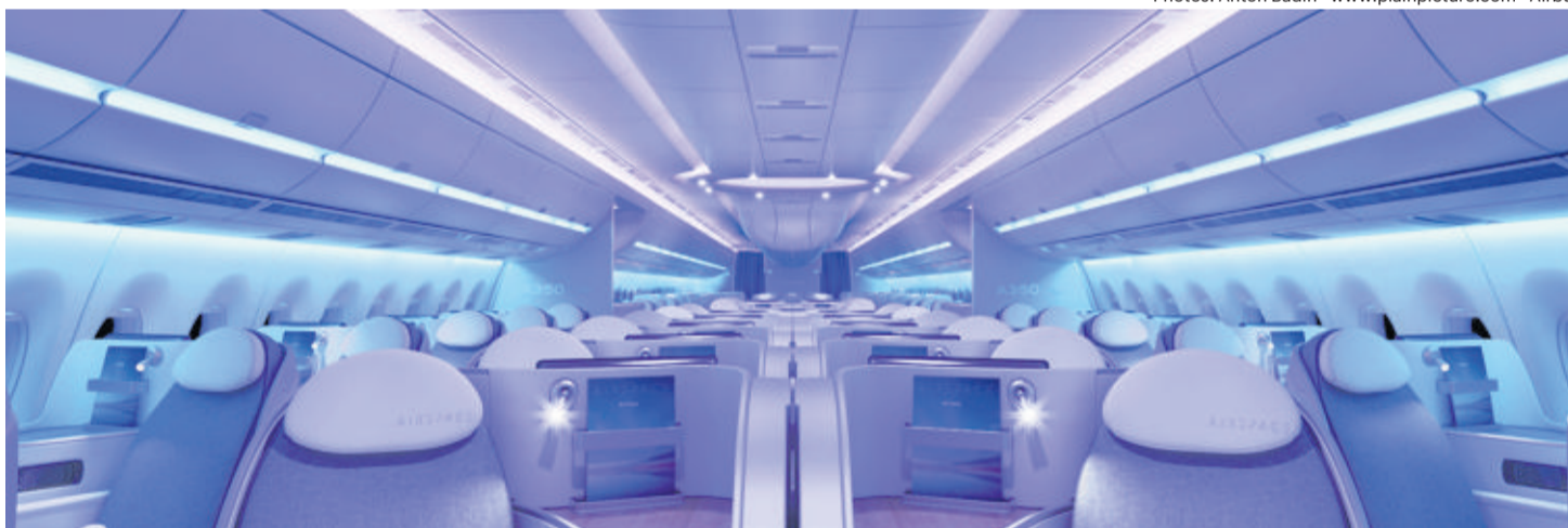
Les LED de l'Airbus A 350 XWB ont plus de 16 millions de combinaisons possibles pour créer 24 atmosphères lumineuses.
